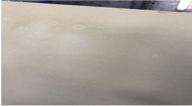
Рис. 40. Обратная ионизация порошковой краски
