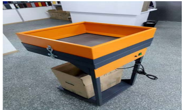
Рис. 43. Просеять порошок перед использованием
