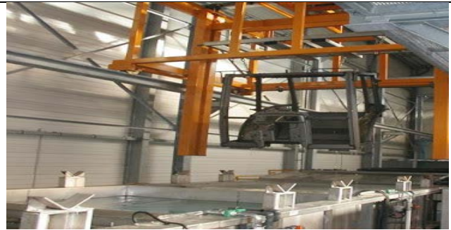
Рис. 12. Корректировка объема раствора в соответствии с изделием
