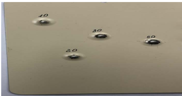
Рис. 81. Некачественная очистка и подготовка поверхности изделия / детали
