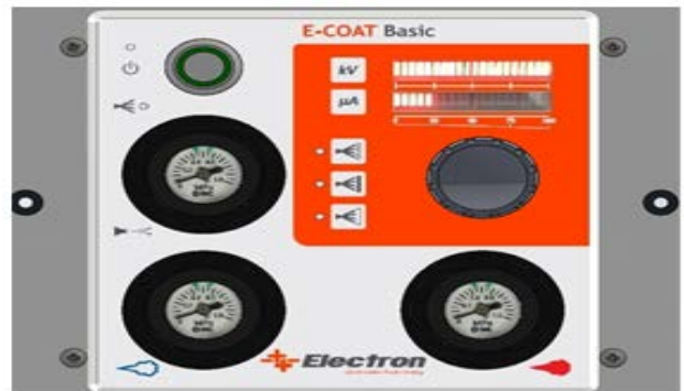
Рис. 26. Отрегулировать манометры подачи краски в соответствии с рекомендациями поставщиков оборудования
