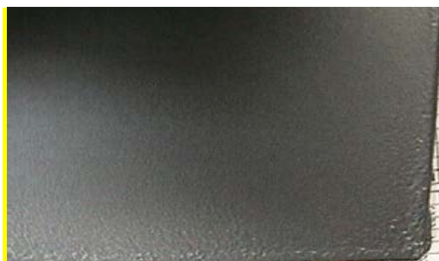
Рис. 52. Эффект «рамки» на краях покрытия
