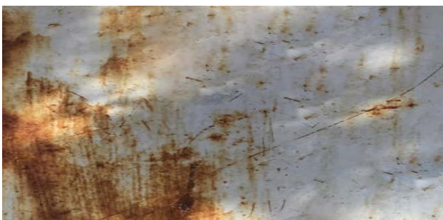
Рис. 13. Ржавчина на конверсионном слое
