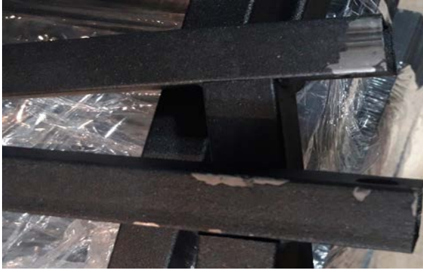
Рис. 68. Слишком медленный прогрев металла
