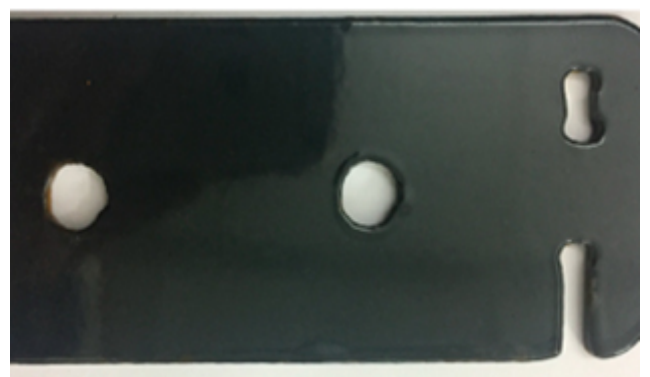
Рис. 86. Использовать порошковую краску, что обеспечивает высокую долговечность покрытия, согласно паспорту качества
