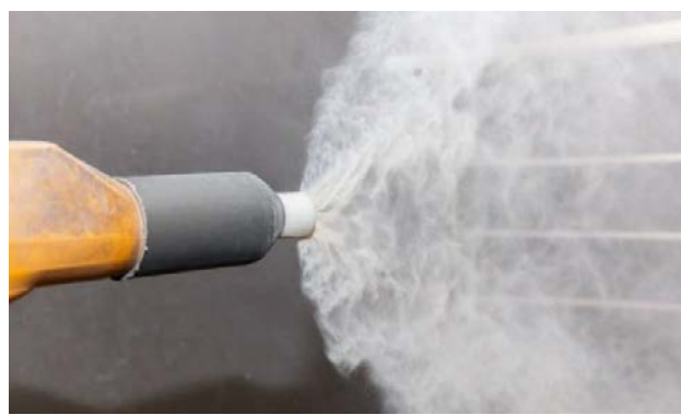
Рис. 53. Отрегулировать угол распыления порошка
