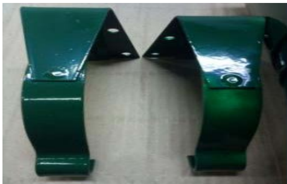
Рис. 32. Недостаточная толщина покрытия
