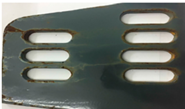
Рис. 85. Порошковая краска не подходит для обеспечения химической стойкости покрытия
