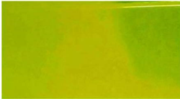
Рис. 74. Недостаточная укрывистость порошкового покрытия
