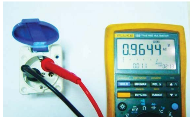
Рис. 28. Проверить сопротивление заземления
