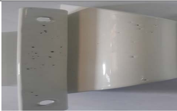
Рис. 46. Кратеры на порошковом покрытии
