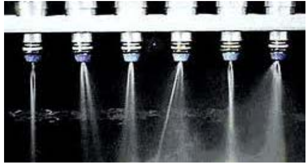
Рис. 18. Форсунки изношены — заменить их
