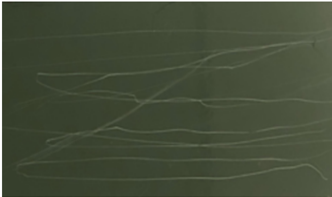
Рис. 83. Поверхность покрытия при упаковке изделий без их охлаждения
