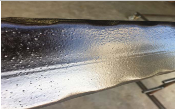
Рис. 50. Дегазация изделия под воздействием высоких температур
