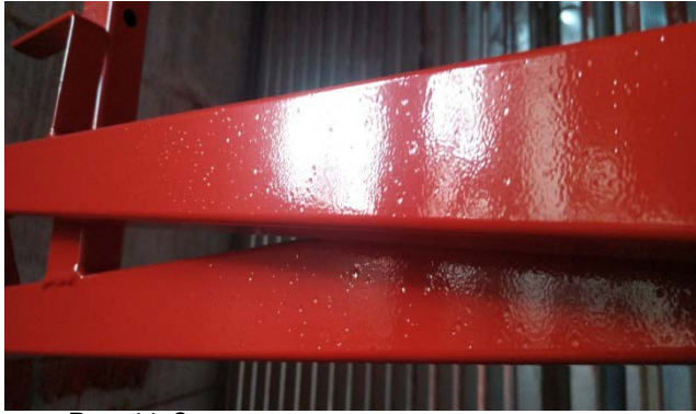
Рис. 44. Засоренность порошкового покрытия
