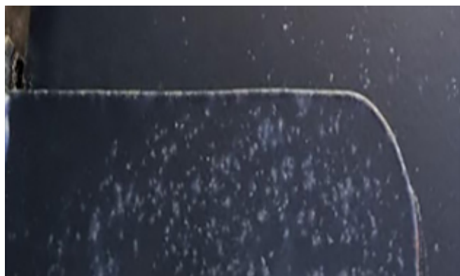
Рис. 87. Эффект цветения на поверхности порошкового покрытия
