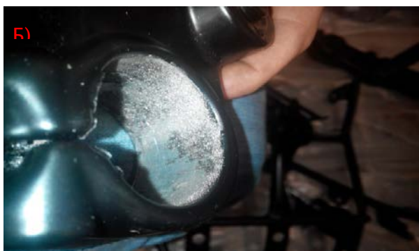
Рис. 29. Плохое проникновение порошка в углубления деталей (А, Б)
